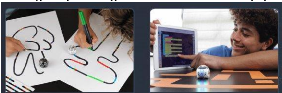
Figura 8: tracciati con codici di colore (sinistra) e ozobot con l'ambiente di programmazione (destra) (immagine da Ozobot & Evolve, Inc. Stati Uniti 2020)
