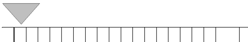
1 pav. Tiuringo mašiną sudarė begalinė popieriaus juosta, skaitymo ir rašymo galvutė ir jos vykdymą valdančios taisyklės. Paveikslėlyje pateiktose taisyklėse aprašytas algoritmas, skirtas patikrinti, ar vienetų skaičius yra lyginis, ar nelyginis.
